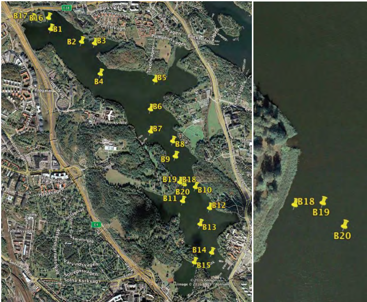
Figur 1 och 2. Vänster: Provtagningsstationer vid sedimentundersökning av Brunnsviken juni 2016. Provtagning på ackumulations- och transportbottnar utfördes vid station B1-15, provtagning av erosionsbotten utfördes vid station B16-20. Vattenprover togs vid station B2 och B12. Höger: Zoomad bild av några provtagningsstationer vid sedimentundersökning av Brunnsviken juni 2016.
